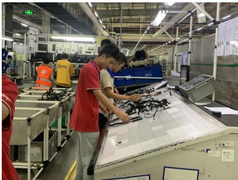
图 1-17 湖南三一工业职业技术学院学生自主研发的“汽车线束智能检测平台”
