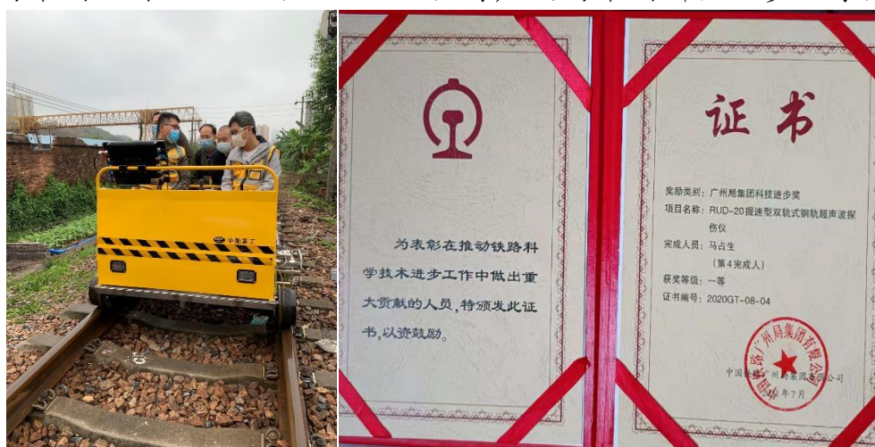
图 5-9 湖南高速铁路职业技术学院“提速型双轨式超声波探伤仪”测试场景与获奖证书
